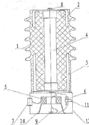
1. 一种检测高压电阻电流的电子式电压互感器,其特征是它包括绝缘壳体(1)、高压屏蔽罩(2)、低压屏蔽罩(3)、高压电阻(4)、高精度电流互感器(5)、航空插头(7)、高压一次接线柱(8)、接地螺栓(9)、电流互感器支架(10)、金属底座盒(12),其中高精度电流互感器(5)通过电流互感器支架(10)安装在金属底座盒(12)内,航空插头(7)、接地螺栓(9)分别安装在金属底座盒(12)箱体上,金属底座盒(12)上端安装低压屏蔽罩(3),低压屏蔽罩(3)引线穿过高精度电流互感器(5)中心与接地螺栓(9)连接,高精度电流互感器(5)二次导线与航空插头(7)连接,低压屏蔽罩(3)内面连接高压电阻(4)下端,高压电阻(4)上端依次连接高压屏蔽罩(2)、高压一次接线柱(8),由环氧树脂将高压电阻(4)、高压屏蔽罩(2)、低压屏蔽罩(3)浇注成一体,形成绝缘壳体(1)。
