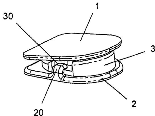
1. 一种椎间盘假体,包括至少三个部分,该至少三个部分包括:一个称为上板(1)的第一板、一个称为下板(2)的第二板、以及一个芯子(3),芯子(3)的上凸表面与上板(1)的下凹表面的至少一部分(10)接触,芯子(3)的下表面与下板(2)的至少一部分上表面接触,并且上板(1)至少可相对于芯子(3)运动,特征在于:在该假体的两边附近有下板(2)和芯子(3)之间配合的相互对着的配合装置,从而限制芯子(3)相对于下板(2)的沿着基本上平行于下板(2)的轴线的移动,并且限制芯子(3)相对于下板(2)环绕基本上垂直于下板(2)的轴线的转动,下板(2)包括与芯子(3)的凹形装置配合的凸形装置。
