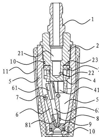
1、一种改良结构的旋转喷头，包括呈管状具有旋流腔（51）的喷头体（5），在旋流腔（51）的一端固定有具有出水口的喷头座（9），在旋流腔（51）的另一端固定有具有进水通道（21）的连接座（2），连接座（2）的外端穿出喷头体（5）连接有进水接头（1），在连接座（2）的内端具有连通进水通道（21）和旋流腔（51）的进水孔（22），其特征在于，所述的连接座（2）内端套设有旋转机构，在旋流腔（51）内倾斜设有喷头组件，喷头组件的一端与喷头座（9）活动连接，另一端与旋转机构相连，当旋转机构旋转时能带动喷头组件旋转。
