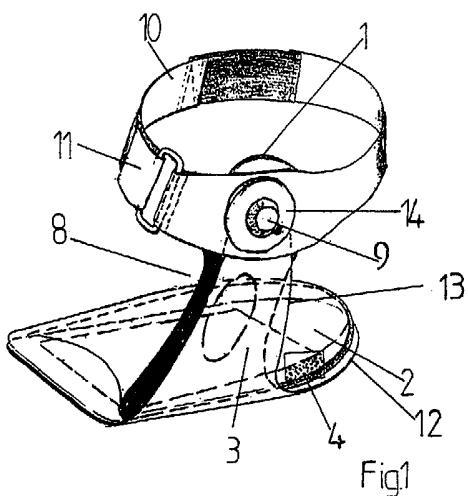
Die Erfindung betrifft eine Vorrichtung zum Massieren eines Unterschenkel, mit einem im Sohlenbereich angeordneten Bodenpolster und einer im Bereich des Unterschenkels angeordneten Blase, wobei zwischen den Innenräumen des Bodenpolsters und der Blase eine schlauchartige Verbindung besteht.
