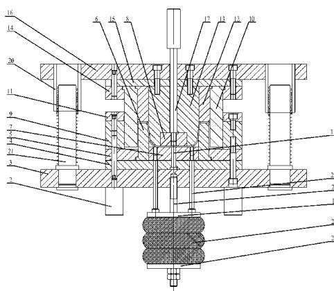
1. 一种具有多种功能的一次成型模具,包括上模板(16)与下模板(3),其特征是:在上模板(16)的边缘部固定有导向套(20),在上模板(16)的下表面中部固定安装有拉伸凸模(13),在拉伸凸模(13)的底端部内部设有打块(8),在拉伸凸模(13)外套接有翻边凹模镶块(12),在翻边凹模镶块(12)外套接有落料翻边凹凸模(10),在落料翻边凹凸模(10)外套接有上固定板(14);在拉伸凸模(13)与上模板(16)内滑动安装有打杆(17),打杆(17)的底端部与打块(8)连接;
