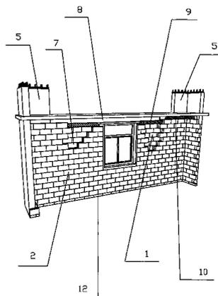
1. 一种用保温砌块砌筑的半内包砌型组合墙体自保温体系,其特征是,该用保温砌块砌筑的半内包砌型组合墙体自保温体系包括A型保温砌块自保温墙体(1),B型保温砌块自保温墙体(2),斜砌砖自保温墙体和梁保温体,门窗周围保温墙体,墙体顶端斜砌砖自保温墙体;具体构造如下:
