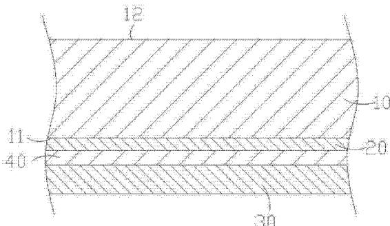
1. 玻璃纤维石膏板表面木装饰板结构,其特征在于:包括玻璃纤维石膏板层、金属漆层以及木装饰板层,其中,该玻璃纤维石膏板层包括表层连接层以及非连接层,该表层连接层以及该非连接层分别位于该玻璃纤维石膏板层的两侧,该金属漆层附着在该玻璃纤维石膏板层的该表层连接层上,该木装饰板层粘连在该金属漆层上,该金属漆层位于该玻璃纤维石膏板层与该木装饰板层之间,在该木装饰板层与该金属漆层之间设置有粘连胶层。
