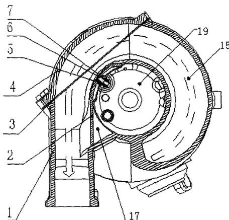
1、一种可变长度的螺旋进气管装置，其特征在于：它包括进气管体（1）、上体盖（4）、叶片阀（2）、共振腔（19）、短管出口（17）、长管出口（18）及调节叶片阀（2）开闭的装置，进气管体（1）为螺旋蜗壳形状，短管出口（17）与长管出口（18）之间互相错开设置；所述的调节叶片阀（2）开闭的装置是执行器（8）通过摇臂（11）带动轴（7）转动的曲柄连杆结构，轴（7）由螺母（10）并紧，上面安装叶片阀（2）；在管体上通过螺栓（13）固定设置限位块（9）来限制摇臂（11）在规定的范围转动。
