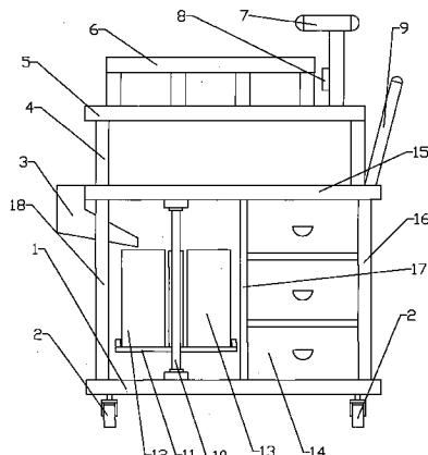
1. 一种护理用换药推车,其特征在于:包括平行设置的底板(1)、中间支板(15)和操作板(5),所述底板(1)与中间支板(15)之间设有左立板(16)、中间立板(17)、右立板(18)和转轴(10),所述左立板(16)和中间立板(17)之间设有抽屉(14),转轴(10)设置在右立板(18)和中间立板(17)之间,所述转轴(10)上固定有托架(11),所述托架(11)上设有第一杂物桶(12)和第二杂物桶(13),所述中间支板(15)的一侧设有下料斗(3),所述下料斗(3)出口设置在第一杂物桶(12)和第二杂物桶(13)的上方,所述操作板(5)上设有紫外线灯(7)。
