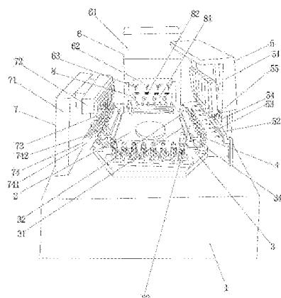
1. 全自动绕线机,其特征在于:包括底座(1)、设在底座(1)上的工件转体(2)、均匀设在工件转体(2)四边上的工件支撑机构(3)、设在每个工件支撑机构(3)一侧的夹线棒(4),所述工件转体(2)四周依次设有绕线装置(5)、焊接装置(6)、卸料进料装置(7);所述工件支撑机构(3)包括底板(31)、通过旋转轴(32)连接在底板(31)上的移动板(33)、转接在底板(31)上的若干电感线圈骨架夹具(34);所述绕线装置(5)包括第一支撑体(51)、设在第一支撑体(51)上的第一活动杆(52)、设在第一活动杆(52)上的出线针头(53)、设在第一支撑体(51)上的定线头(54)、设在定线头(54)一侧的剪刀(55)。
