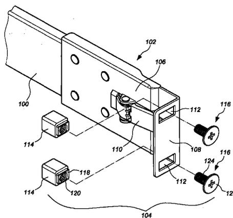
1. 一种用于安装托架的挂栓总成,该安装托架包含一侧板及一端板由该侧板的一端垂直地延伸,该端板具有一长槽孔,该挂栓总成包括栓体、凸体及固定组件,其特征在于:
