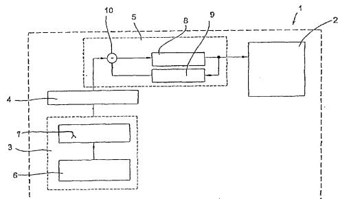
1. 一种在具有一异步电路（2）的数字集成电路（1）中预防外部侦测操作的方法，该方法包含随时间变化该异步电路（2）的一供应电压，以时间位移该异步电路中操作执行时间的步骤。
