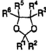
worin jedes von R<sup>1</sup> bis R<sup>6</sup> unabhängig ein Wasserstoffatom oder eine Kohlenwasserstoffgruppe mit 1 bis 18 Kohlenstoffatomen darstellt, und mindestens eines von R<sup>1</sup> bis R<sup>6</sup> eine Struktur eines Esters oder Amides von (Meth)acrylsäure als Substituenten an einem Ende davon hat.
