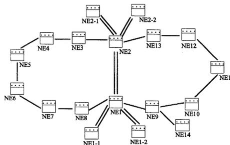
1. 一种网络上所有链路业务流量统计的显示方法，在由网络网元节点及其相互连接的链路构成的网络拓扑图上，显示两网络网元节点间链路上所统计的业务资源使用情况，其特征在于包括：
