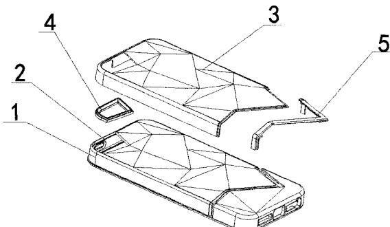
1. 一种外层碳纤内层橡胶的双层保护壳,其特征在于:包括内层,所述内层为TPU橡胶材质,所述内层中部设有容纳手机的容腔,所述内层上部设有手机照相镜头通孔,所述内层外部设有外层,所述外层为设有碳纤维布的外层,所述外层上部设有对应内层手机照相镜头通孔的通孔,所述外层的通孔部位设有第一塑胶件,所述外层下部设有第二塑胶件,所述内层上部设有对应第二塑胶件的凹槽。
