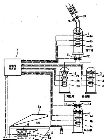
1. 一种用于人体的热疗仪，其配备有一个容器和一个控制设备，所述容器中装满液体，并且除了头部之外能将整个人体浸没在所述液体中，所述控制设备用来将所述几乎整个人体的温度控制到一个预定温度，以便进行治疗。
