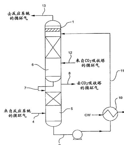
1.在生产环氧乙烷的工艺中热量回收的改进方法，包括将环氧乙烷从循环气中洗出，洗涤后的循环气流与热碳酸盐吸收塔溶液进行接触来吸收  $\text{CO}_2$ ，将  $\text{CO}_2$  吸收步骤后的循环气流再循环到环氧乙烷生产过程，改进之处包括在第一接触步骤中将来自环氧乙烷移出单元的洗涤后循环气流与热的含水液接触，以将循环气加热和从中洗出所含的环氧乙烷，并冷却所述含水液，将加热的循环气送入热碳酸盐吸收步骤来移出  $\text{CO}_2$ ，将来自碳酸盐吸收单元的循环气通过在第二接触步骤中与所述来自第一接触步骤冷却所述含水液之后的含水液进行接触使其冷却并从中移出碳酸盐，将含水液从第二接触步骤送到第一接触步骤，和将冷却后的循环气从第二接触步骤送到环氧乙烷反应单元。
