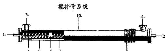
1. 一种连续流动系统,其包括包含一个或更多个搅拌单元的通道,所述搅拌单元具有不同于所述通道中的其它材料的密度,所述通道具有用于材料的一个或更多个入口和用于材料的一个或更多个出口,穿过所述通道的材料经受有序流动,并且通过摇振所述通道产生搅拌物运动,并且混合的方向大致横向于材料流动通过所述通道的方向。
