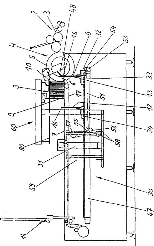
Uppfinningen avser ett förfarande och en anordning för åstadkomande, stöd, avskiljning och transport av staplar, speciellt staplar (10, 11 resp. 10a, 11a) av brevkuvert (3) eller liknande efter en avlämningsanordning (4, 4a), som placerar kontinuerligt och ett och ett inkommande brevkuvert (3, 3a) med en kant (6, 6a) på staplingsytan (7, 7a).
