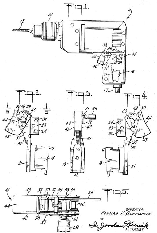
MULTI-POSITION LOCK FOR TRIGGER SWITCH
