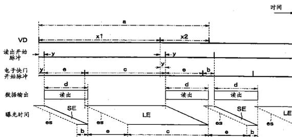
1. 一种摄像装置,其进行如下摄像:能够通过交替地反复进行长时间曝光和短时间曝光,来合成扩展了动态范围的图像数据,
