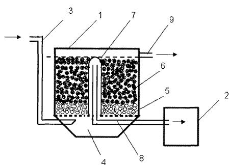
1、一种兼具增氧和反冲洗功能的无动力生物滤池，其特征在于：生物滤池（1）上部为生物过滤区，下部为锥体形污泥沉淀区，生物滤池（1）上方开口与大气相通，进水口（3）与污泥斗（4）相连，净化水出口（9）位于生物过滤（6）的上方，虹吸反冲洗增氧套管（7）的上沿与生物滤料（6）上方的出水口（9）持平，虹吸反冲洗增氧套管（7）的下沿位于生物滤料支承架（5）空隙中，反冲洗出水管（8）在虹吸反冲洗增氧套管（7）内并穿过滤料支承（5）由锥体形污泥沉淀区引出至二沉池（2）。
