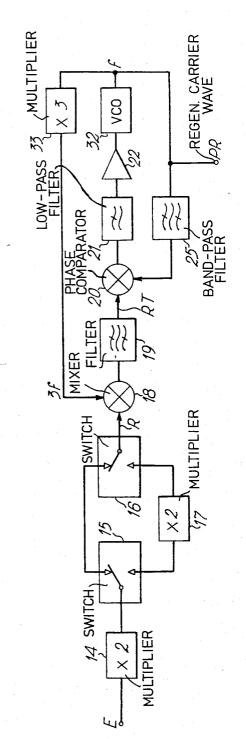
CARRIER WAVE REGENERATING DEVICE WITH PHASE LOCKED LOOP
