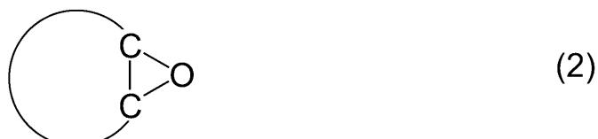
で表される化合物のように、エポキシ基を構成する炭素原子が直接脂環式環を構成している化合物が挙げられる。
