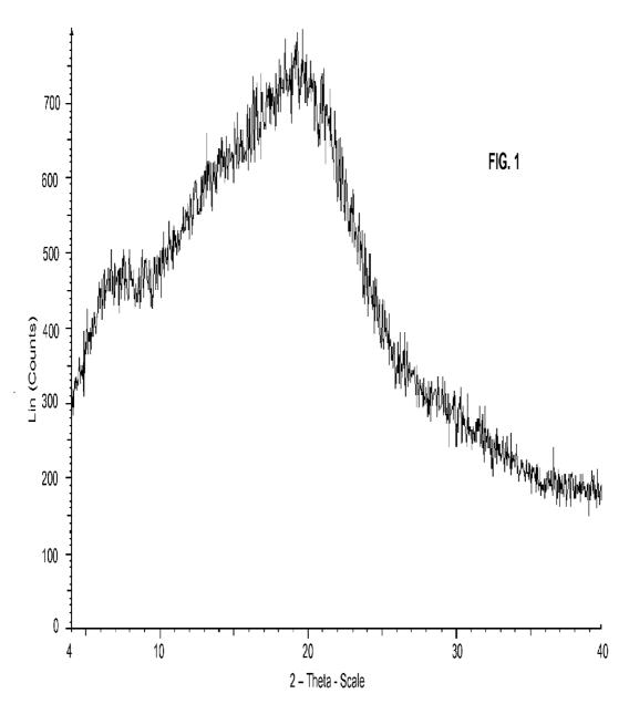
$10/90 \; \text{FP/DPS} \; (3448-045) - \text{File:} \; 3448-045. \\ \text{raw} - \text{Type:} \; 2\text{Th alone} - \text{Start:} \; 4.000^\circ - \text{End:} \; 40.000^\circ - \text{Step:} \; 0.040^\circ - \text{Step:} \; \text{time:} \; 2 \; \text{s} - \text{Temp:} \; 25^\circ \text{C} \; (\text{Room}) - \text{Time} \; \text{Started:} \; 15 \; \text{s} - 2 - \text{Theta:} \; 4.000^\circ - \text{Theta:} \; 3.000 \; \text{Operations:} \; \text{Import}$
