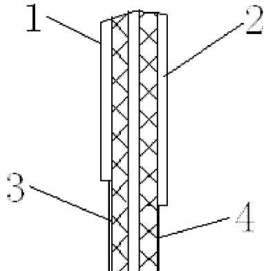
1. FPC 的金手指,包括焊接面的金手指和非焊接面的金手指,其特征在于 :所述焊接面的金手指和非焊接面的金手指的长度不等。
