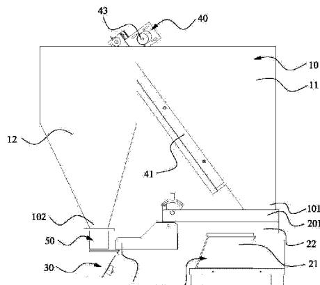
1. 一种用于颗粒包装机的下料装置,其特征在于:包括有主料斗、补给料机构以及装料斗;该主料斗具有第一容置腔和第二容置腔,该第一容置腔的底部设置有第一出料口,该第一容置腔内设置有用于将第一容置腔内的物料输送至第二容置腔内的粗给料机构,该第二容置腔的底部设置有第二出料口;该补给料机构设置于主料斗的下方,该补给料机构的进料口连通前述第一出料口,该装料斗设置于该补给料机构之出料口以及前述第二出料口的下方。
