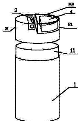
1. 一种包装纸筒，包括主体(1)和盖体(2)，主体(1)一端延伸出连接管(11)，其特征在于：所述盖体(2)上部内设有卷笔刀(3)和一个独立的腔体(21)，所述腔体(21)内设有橡皮擦(4)，腔体(21)上设有活动盖(22)，所述连接管(11)套接于盖体(2)下部。
