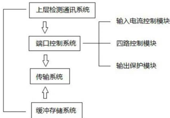
1. 一种云平台连接端口控制装置,包括端口控制系统、上层检测通讯系统、传输系统和缓冲存储系统,
