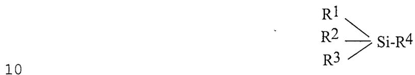
dans laquelle  $R^1$ ,  $R^2$  et  $R^3$  qui peuvent être identiques ou différents, sont choisis parmi les groupes alcoxy en  $C_1$  à  $C_3$  et les atomes d'halogène, et  $R^4$  est un groupe hydrocarboné ou fluorocarboné, linéaire ou ramifié.
