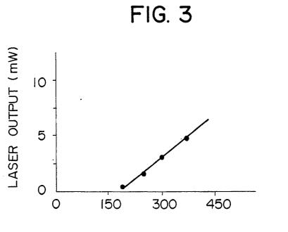
LASER DIODE INPUT POWER (mW)
