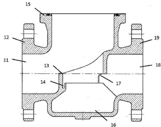
1. 一种流量计壳体,其特征在于,其包括:流入管、流出管、位于所述流入管和流出管中间的套管,以及沿套管底部一体延伸的固定部;
