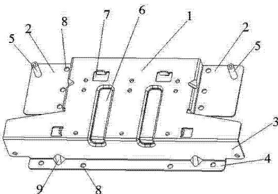
1. 显示屏支架，其特征在于，包括：支架主体，上述支架主体下方一体成型有支撑座，上述支撑座下方一体成型有安装座，上述支架主体垂直于支撑座，上述支撑座垂直于安装座；上述支架主体的两侧弯折形成有对称的主体安装部，上述主体安装部设有定位柱；上述支架主体形成有两个限位结构和若干定位结构；上述主体安装部、支架主体、安装座和支撑座均形成有若干固定孔。
