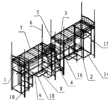
1. 一种新型公寓组合家具,包括主体支架,主体支架内设置有两张床(7)、两个柜子(14)和两台电脑桌(18),其特征在于:所述的床(7)固定在左右榻(1)之间,床(7)的下面设置有内中榻(2),内中榻(2)处设置为电脑桌(18),电脑桌(18)上设置有书架(16),电脑桌(18)的一侧安装柜子(14),两张床(7)之间为中榻(5),中榻(5)处设置有楼梯(4),其中电脑桌(18)包括加强桌面(9),加强桌面(9)下面设置有键盘板(8),键盘板(8)的一侧安装有摆放主机用的主机架(10)。
