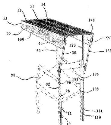
1. 一种户外家具的框架和遮篷，包括：遮篷和框架，框架具有至少两个支撑臂，框架支撑遮篷，框架能够在头顶上位置、家具后面的位置和任何中间位置定向。
